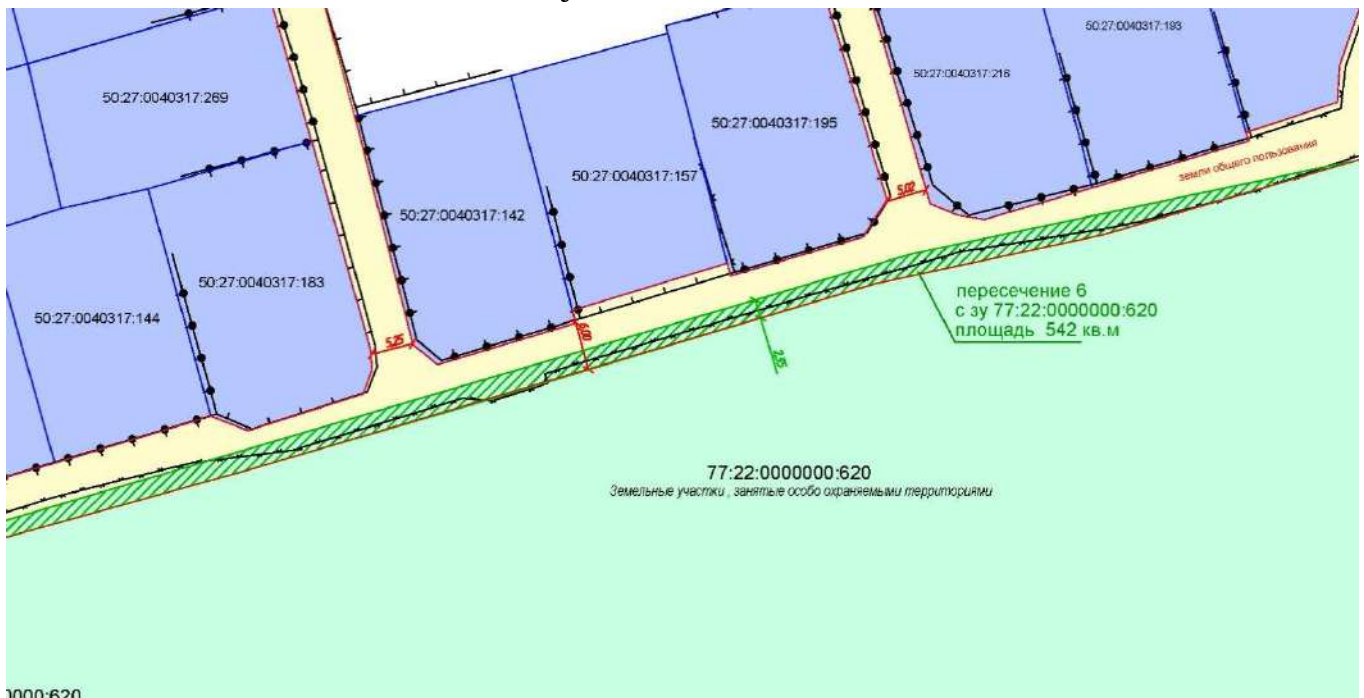
Схема 10. Пересечение проектируемых земель общего пользования СНТ "Сосны" с земельным участком с КН 77:22:0000000:620.
